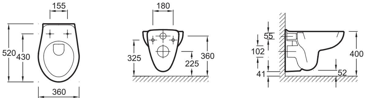
Description : Cuvette suspendue. E4345. Collection : BRIVE. Dimensions : 52 x 36 cm. Poids : 14,5 kg. Matériau : Céramique. Type d'installation : Suspendu. Consommation d'eau : 2,6/4 L et 3/6 L. Hauteur : Standard. Type de bride : Ouverte (traditionnelle). Cuvette semi carénée.
